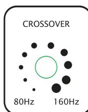
La fréquence de croisement détermine quelles fréquences seront amplifiées par le caisson sous-grave. Cette fréquence de coupure peut être contrôlée manuellement et est continuellement variable entre 80-160Hz. Vous pouvez expérimenter avec la position de cette commande jusqu'à ce que les basses fréquence produites par le caisson soient bien intégrées avec le son de vos enceintes principales.
