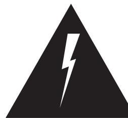
Ce symbole de sécurité vise à avertir l'utilisateur que le boîtier contient un voltage dangereux non isolé, suffisamment puissant pour constituer un risque d'électrocution.
